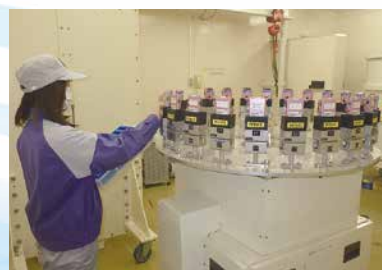
電子式線量計の校正作業 (中央に放射線源を置き周囲の測定器を校正)
