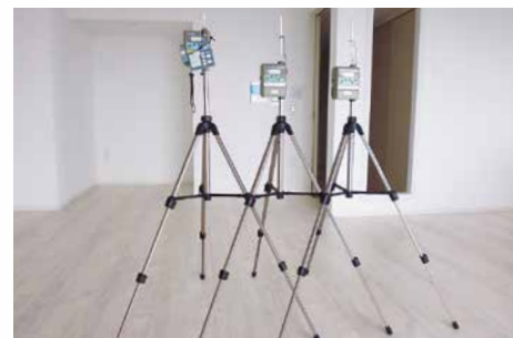
室内環境測定(吸引法)
