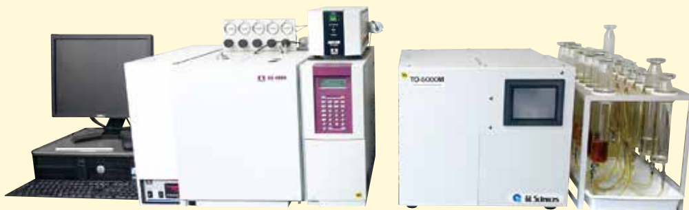
油中ガス分析用ガスクロマトグラフ
