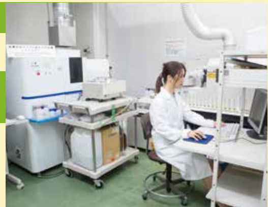
誘導結合プラズマ発光分析装置 誘導結合プラズマ質量分析装置
