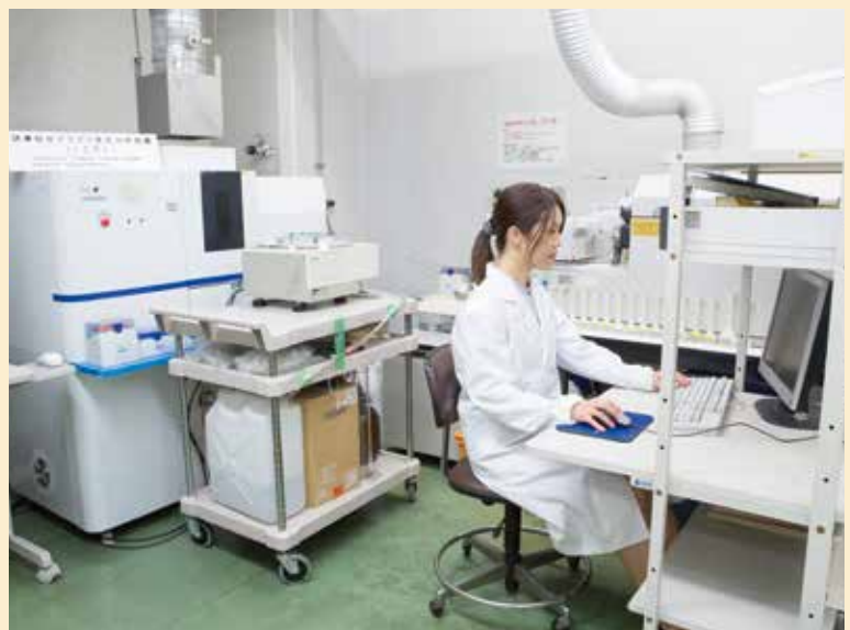
誘導結合プラズマ発光分析装置 誘導結合プラズマ質量分析装置
