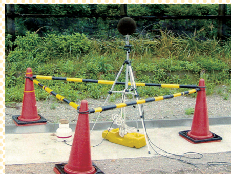
敷地境界での騒音・振動調査
