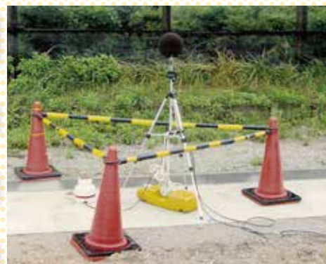
敷地境界での騒音・振動調査
