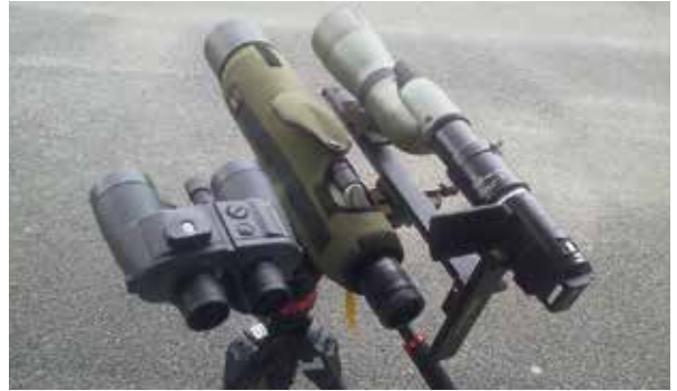
定点調査機材 左から 7倍双眼鏡、20~60倍望遠鏡、コリメート方式撮影機材
