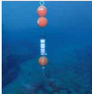
固定型受信機での調査
