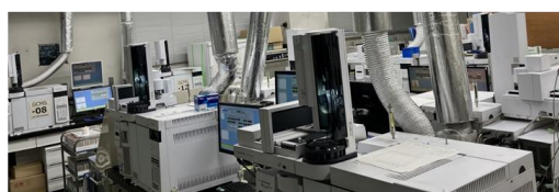
前処理試料を分析する GC-MS
