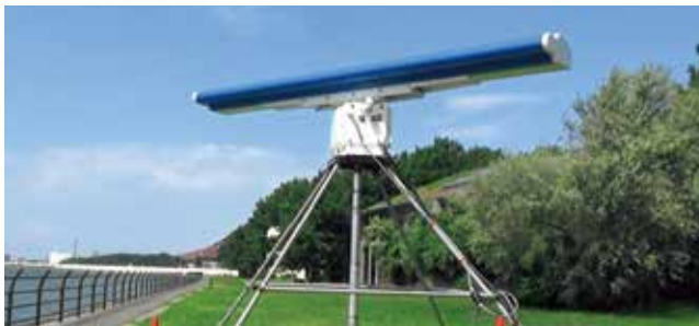
飛翔経路観測(水平観測)用 Sバンドレーダー・スキャナー部
